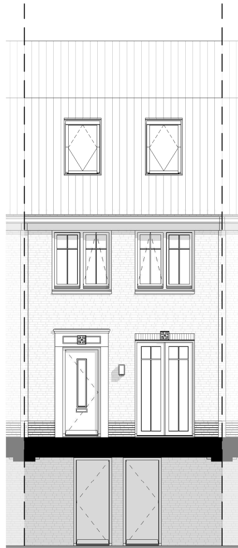
Optie 30232 - Derde verdieping: - dakvenster in badkamer (voorgevel)
