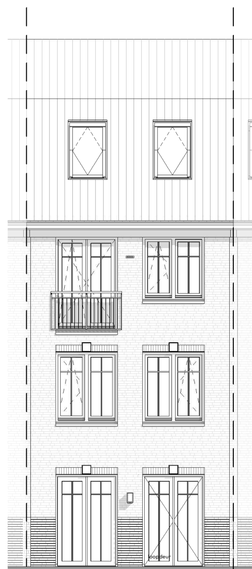
Optie 30242 - Derde verdieping: - dakvenster in techniek (achtergevel)
