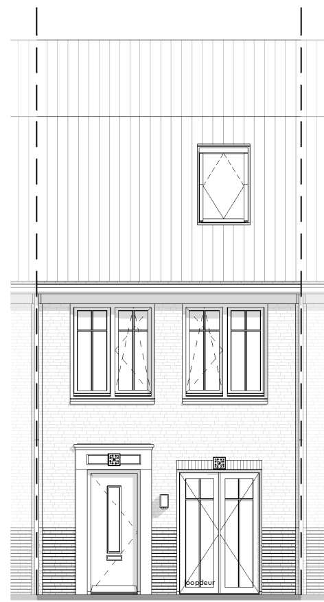
Optie 30001 - Begane grond: - openslaande deuren (voorgevel)
