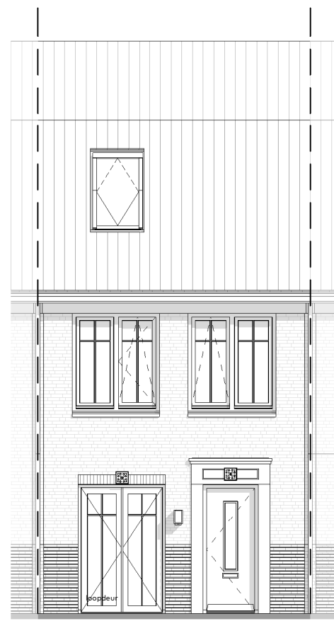
Optie 30001 - Begane grond: - openslaande deuren (voorgevel)
