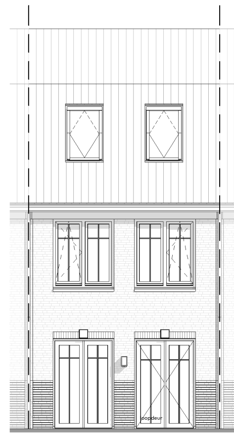
Optie 30242 - Tweede verdieping: - dakvenster in techniek (achtergevel)
