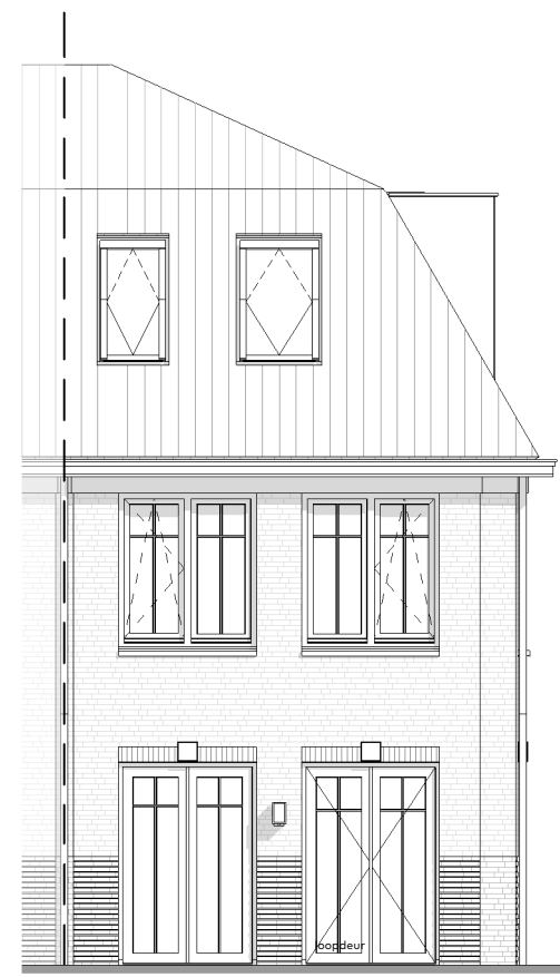
Optie 30242 - Tweede verdieping: - dakvenster in techniek (achtergevel)
